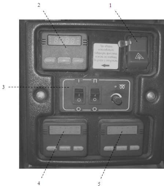
Рис. 3.3 Пульт управления отопителями
