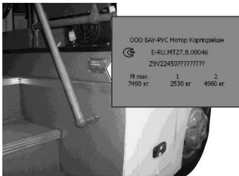
Рис. 1.6 Табличка заводских данных
