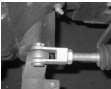
Рис. 5.20 Механизм регулировки свободного хода вилки на рабочем цилиндре сцепления
