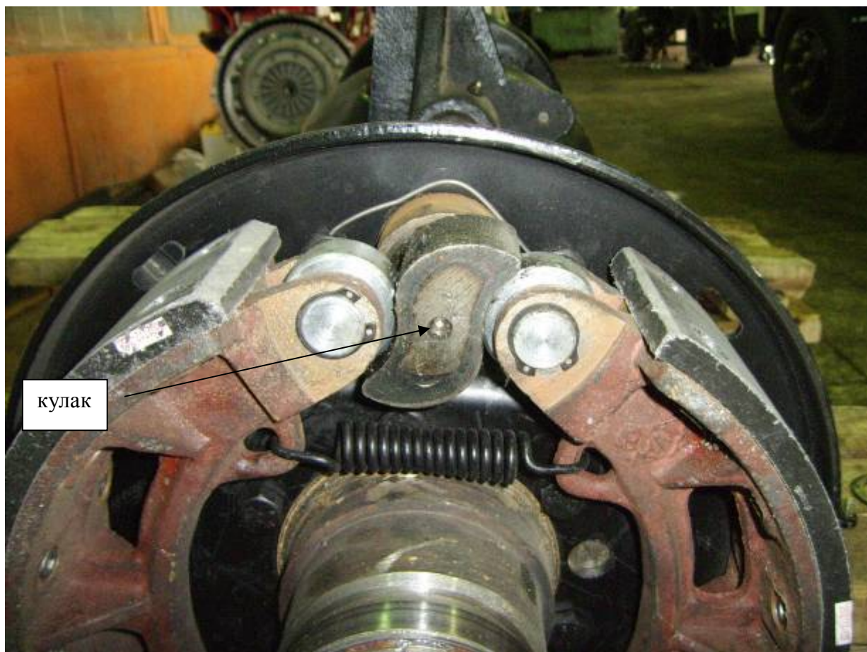
Рис. 14 Положение разжимного кулака после установки механизма (вид сбоку)
