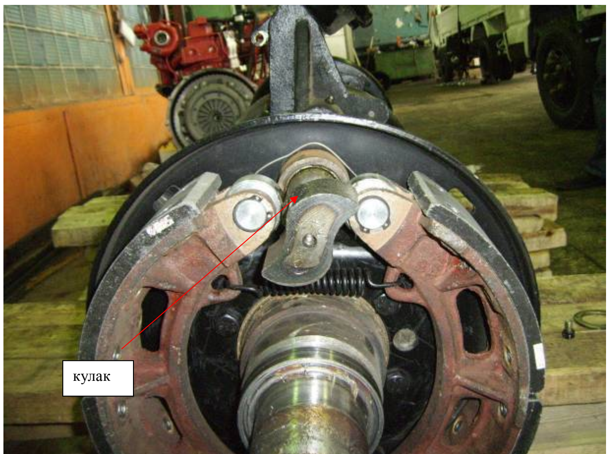
Рис. 11 Положение разжимного кулака перед установкой механизма (вид сбоку)
