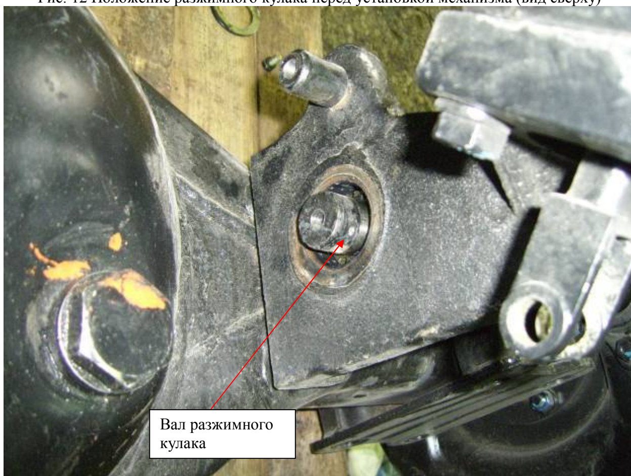
Рис. 13 Положение вала разжимного кулака перед установкой механизма
