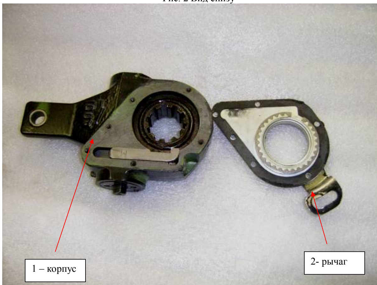
Рис. 3 Вид сверху со снятым опорным рычагом с сектором
