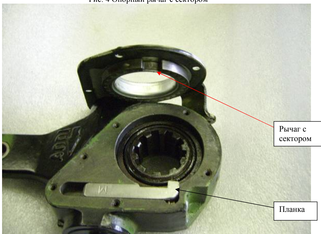
Рис. 5 Взаимное положение планки храпового механизма и сектора опорного рычага
